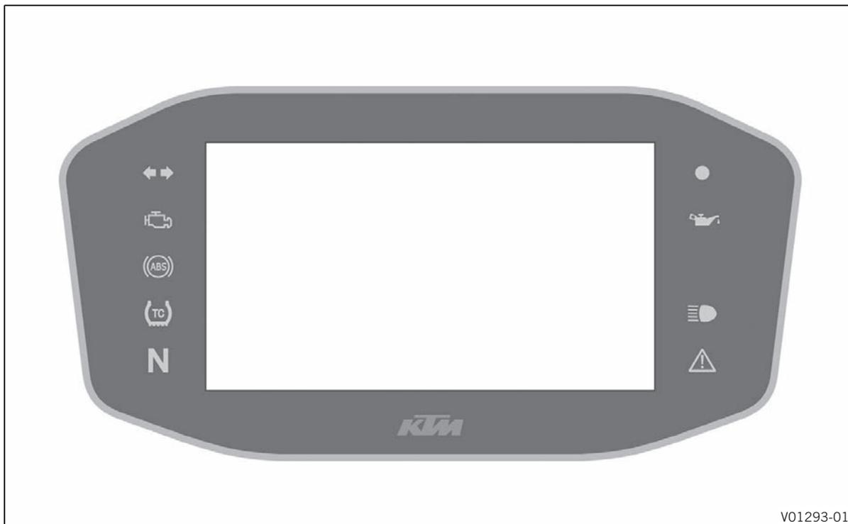
Индикаторные лампы снабжают водителя дополнительной информацией о рабочем состоянии мотоцикла. При включении зажигания все индикаторные лампы кратковременно загораются.
