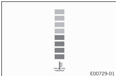
Индикатор температуры охлаждающей жидкости состоит из сегментов. Большее количество активных сегментов соответствует более высокой температуре охлаждающей жидкости.
