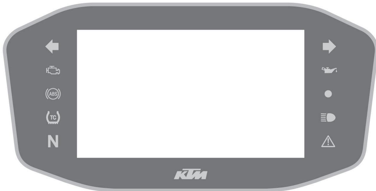
Индикаторные лампы снабжают водителя дополнительной информацией о рабочем состоянии мотоцикла.
