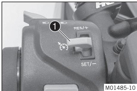
Перекидной переключатель системы круиз-контроля **1** расположен на левой стороне комбинированного переключателя.
