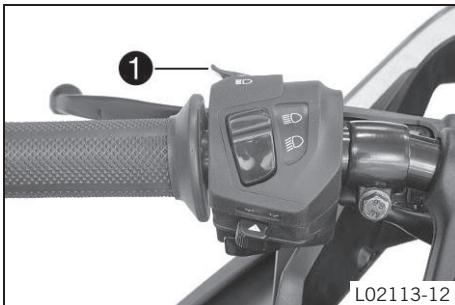
Выключатель светового сигнала **1** расположен на левой рукоятке руля.
