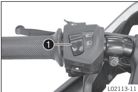
Выключатель освещения **1** расположен на левой рулевой рукоятке.
