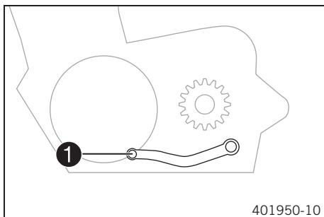
Рычаг переключения передач ① расположен на левой стороне двигателя.
