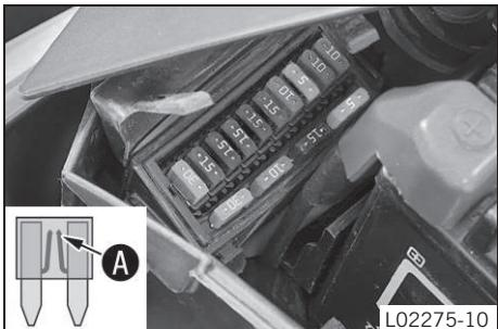
Предохранитель **1** - 30 А - главный предохранитель
