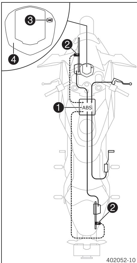
Антиблокировочное тормозное устройство **1**, состоящее из гидравлического блока, блока управления ABS и возвратного насоса, установлено под седлом. На переднем и заднем колесах размещены датчики частоты вращения колеса **2**.
