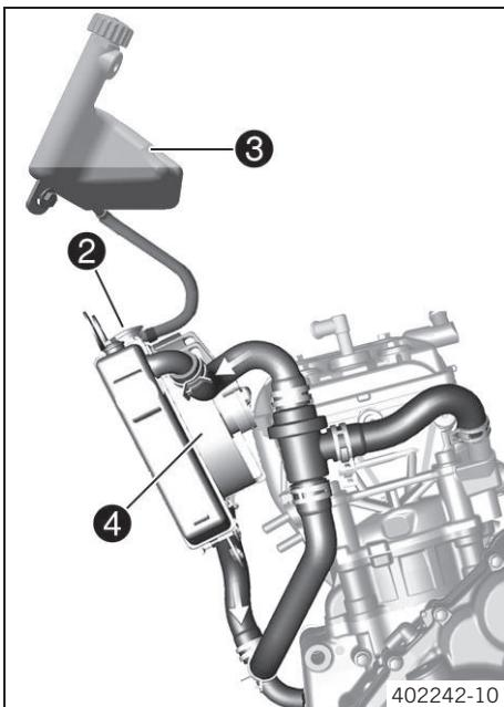
Охлаждение жидкости при движении мотоцикла осуществляется за счет обдува радиатора встречным потоком воздуха, а также за счет наличия вентилятора радиатора ④, который управляет термодатчиком.
