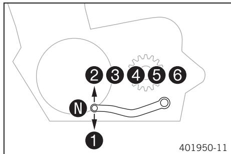
Схема расположения передач показана на иллюстрации.
