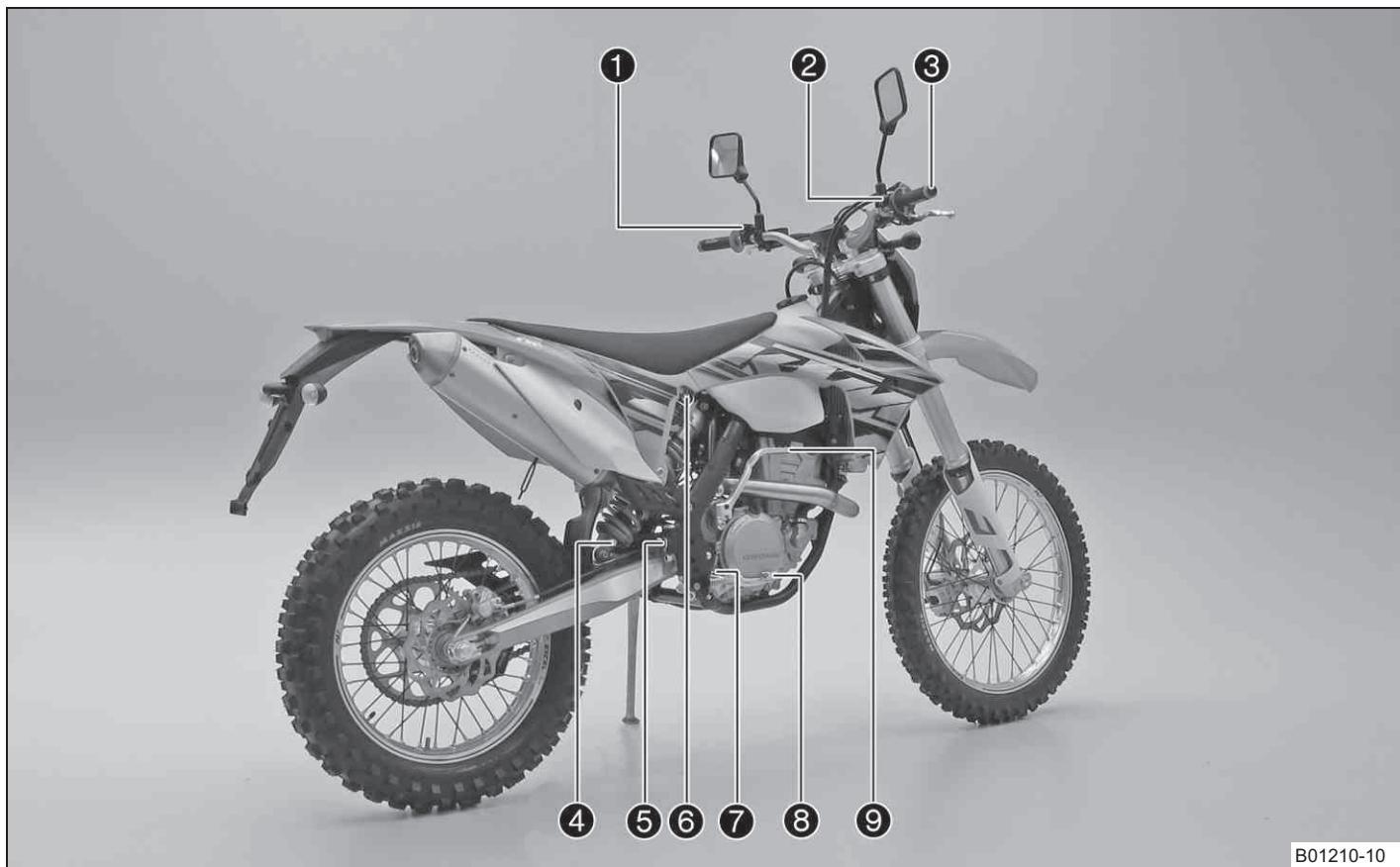
1 Электронный выключатель зажигания (☞ стр. 14)
