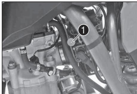
Кнопка холодного пуска ① расположена слева на корпусе дроссельного клапана.
