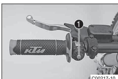
Электронный выключатель зажигания ① расположен на левой рукоятке руля.
