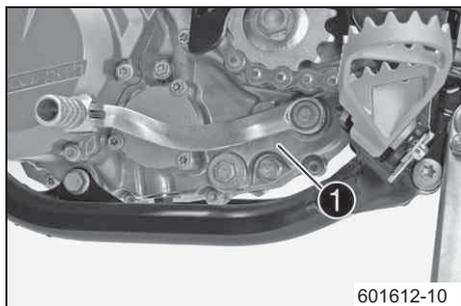
Номер двигателя ❶ выбит на левой стороне силового агрегата, под ведущей звездочкой.
