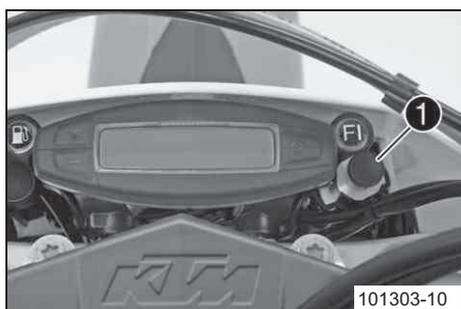
Переключатель освещения ❶ расположен справа от спидометра.
