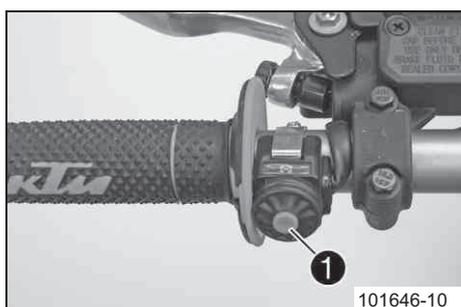
Электронный выключатель зажигания ❶ расположен на левой рукоятке руля.
