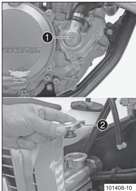
Водяной насос ❶ в двигателе обеспечивает поток охладителя.
