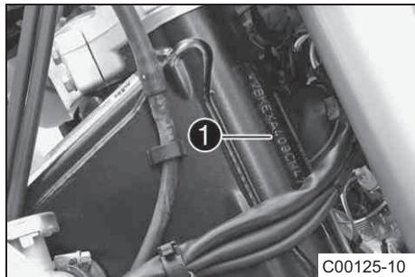
Номер шасси ① выбит справа от рулевой колонки.
