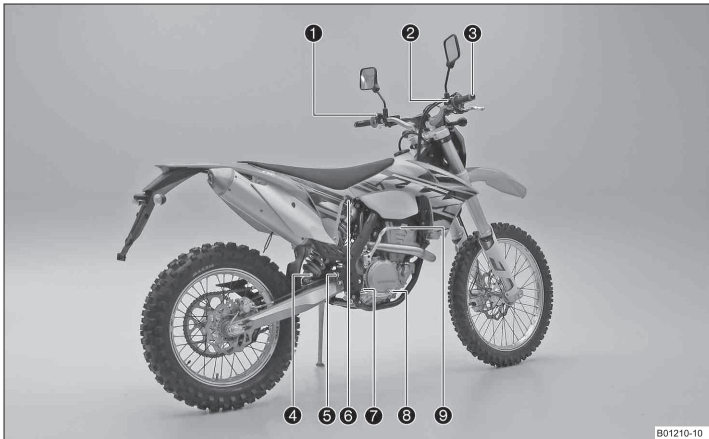
1 Электронный выключатель зажигания (☞ стр. 14)
