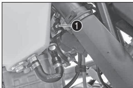
Винт регулировки числа оборотов холостого хода ① расположен на корпусе дроссельной заслонки в верхней левой части. Винт регулировки числа оборотов холостого хода имеет две функции. При поворачивании винта осуществляется управление числом оборотов холостого хода. При его полном вытягивании увеличивается число оборотов холостого хода во время холодного пуска.
