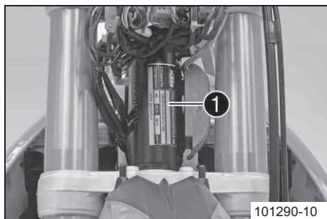
Табличка с указанием типа ① крепится на передней части рулевой колонки.
