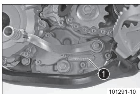
Номер двигателя ① выбит на левой стороне силового агрегата, под ведущей звездочкой.
