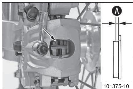
Проверить тормозные колодки на минимальную толщину ④.
