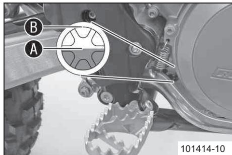
Уровень моторного масла находится между серединой отметки **A** и верхним краем отметки **B**.
