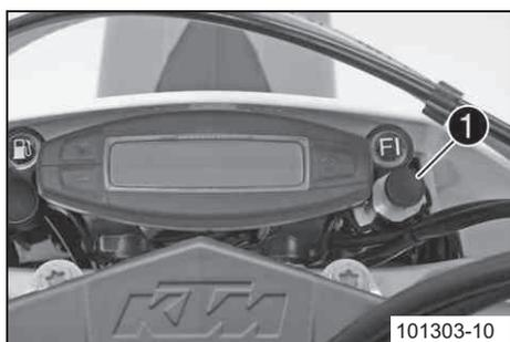
Переключатель освещения ❶ расположен справа от спидометра.
