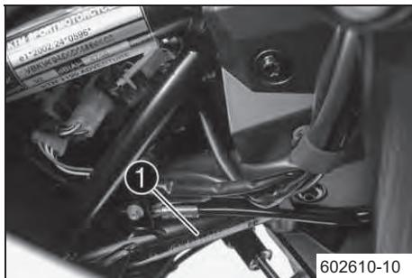
Номер шасси ❶ выбит внизу справа на раме под рулевой колонкой.
