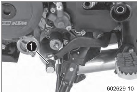
Рычаг переключения передач ① расположен с левой стороны двигателя.
