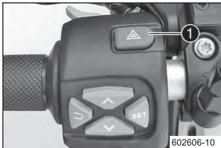
Выключатель аварийной сигнализации ❶ находится слева на комбинации переключателей. Выключатель аварийной сигнализации используется для сигнализации об аварийных ситуациях.
