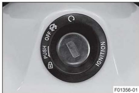
Замок зажигания/рулевой колонки расположен перед верхней траверсой.
