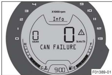
При возникновении ошибки в CAN-шине на дисплей выводятся различные предупреждения:
