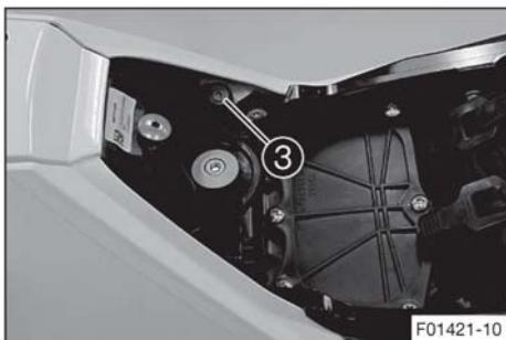
Снимите винт **3**.
