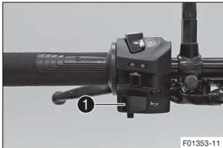
Кнопка звукового сигнала **1** расположен в левой части руля.
