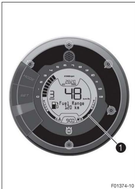
Содержимое топливного бака отображается в зоне 1 дисплея. Индикатор уровня топлива представляет собой шкалу с делениями. Чем больше делений светится, тем больше топлива в топливном баке.
