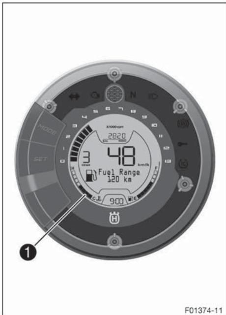
Индикатор температуры охлаждающей жидкости отображается в сегменте 1 дисплея.
