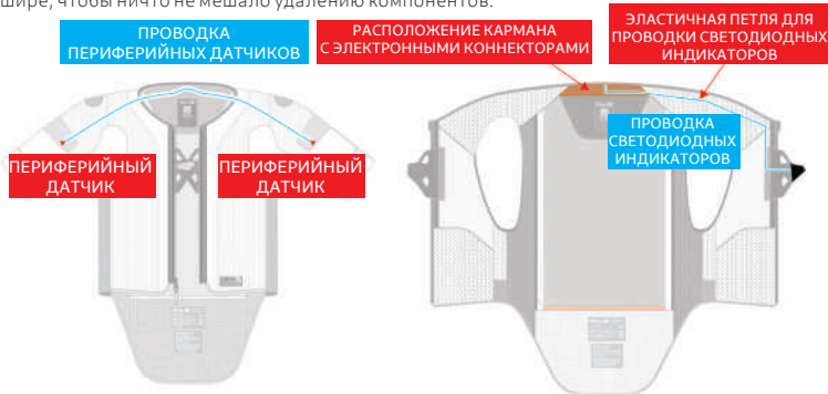
Рисунок 15: Расположение электронных компонентов на базовом слое системы (1)
