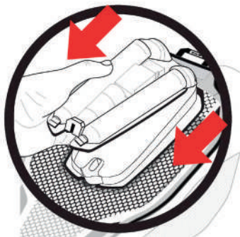
Рисунок 17: Как извлечь подушку безопасности и все электронные компоненты из задней части системы
