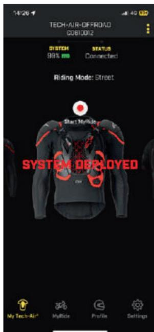
Рисунок 18 — Отображение статуса системы после срабатывания подушки
